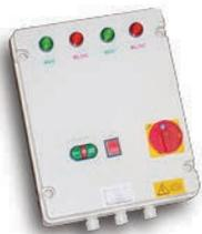
Quadri elettrici in scatola stagna con protezione termica motore. Dotati di pulsanti di comando separati per i motori di aspirazione ed immissione. Adatti al montaggio su linee elettriche senza protezione differenziale. Pulsantiera 24 Volts e sezionatore blocco porta. Protezione IP 55.
