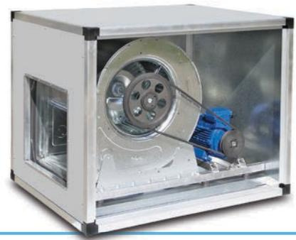
Costruzione in profili estrusi di alluminio e pannellatura a parete doppia: **esterna in lamiera plastificata, interna in lamiera zincata**, coibentazione in poliuretano espanso.
