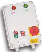
Quadri elettrici in scatola stagna con protezione termica motore. Adatti al montaggio su linee elettriche senza protezione differenziale. Pulsantiera 24 Volts e sezionatore blocco porta. Protezione IP 55.
