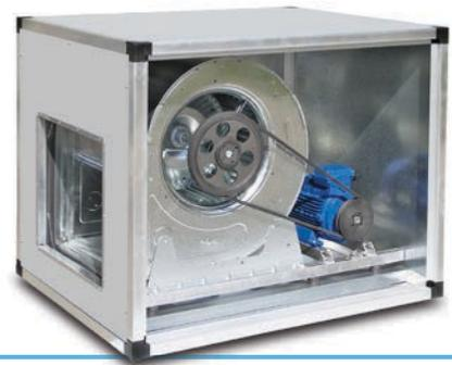
Costruzione in profili estrusi di alluminio e pannellatura a parete doppia: **esterna in lamiera plastificata, interna in lamiera zincata**, coibentazione in poliuretano espanso. Ventilatori doppia aspirazione pale in avanti, motore con trasmissione a cinghia e puleggia. Per gli impianti di aspirazione si consiglia la versione B.
